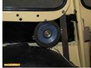
Enceinte fixée sur la 1ère plaque
