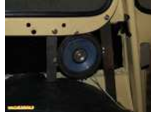
Pose de l'enceinte terminée
