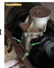
Visser 4 goujons aux extrémités du bloc moteur au plus près des paliers de vilebrequin. Ces goujons permettront de faciliter le centrage et la pose des joints en liège et du carter.
