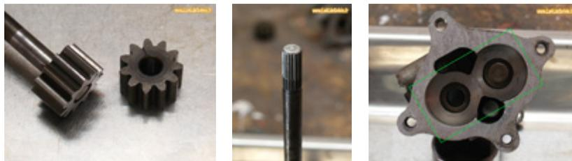
Contrôler l'état du plan de joint du couvercle et le surfacer à la toile Emeri s'il est marqué.
