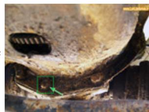
Enfin, retirer les 3 vis de fixation de la pompe à huile sur le bloc moteur et déposer la pompe.
