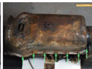
Une fois le carter déposé, remettre en place la vis inférieure de la boîte de vitesse pour éviter que l'huile de la boîte ne coule.
