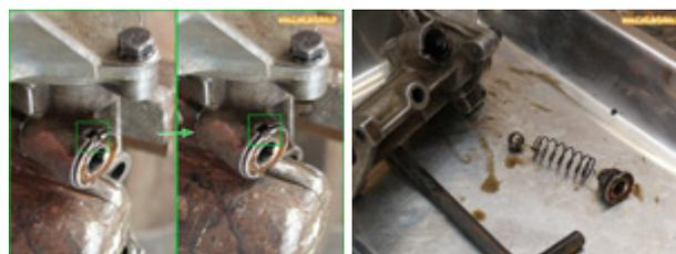
Retirer les 4 vis de fixation du couvercle et sortir le pignon fou et le pignon d'entraînement.
