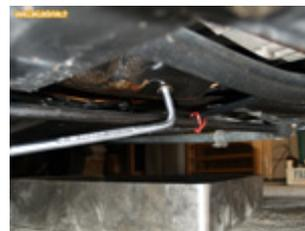
Retirer les 4 écrous et rondelles de la traverse tubulaire et repousser les vis au maximum vers l'arrière. Faire ensuite pivoter la traverse tubulaire pour la déposer (certains trous de la traverse sont ouverts permettant de la faire pivoter même si les vis ne sont presque pas repoussées).
