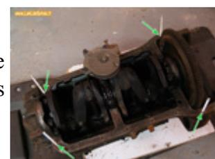
Positionner en premier le joint de palier "arrière", c'est à dire le palier de vilebrequin **coté distribution** et enduire ses extrémités de pâte à joint **adaptée**.
