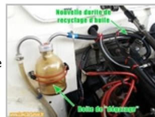
Sur ce bocal, monter une durite qui sera reliée au reniflard du cache culbuteurs, et une mise à l'air libre. La durite et la mise à l'air libre doivent avoir un diamètre sensiblement identique à la durite original du système.
