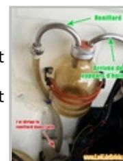
Il faut aussi boucher les durites d'origines du système : une sur le corps du carburateur et une sur la pipe d'admission. Un boulon de bon diamètre et un collier et le tour est joué.
