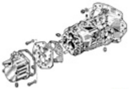
BOITE DE VITESSES TYPE 334 (4 vitesses toutes synchronisées)
