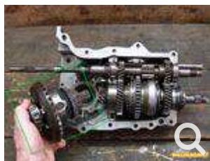
Commencer par déposer le différentiel comme décrit dans le tutoriel de démontage complet d'une boite de vitesse 334.
