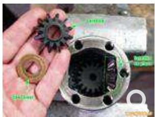
Déposer ensuite l'axe des satellites puis déposer l'axe les 2 satellites avec leurs coussinets.
