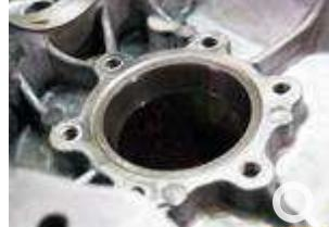
Au marteau ou à la presse reposer les roulements en tapant uniformément sur la bague extérieure à l'aide d'un tube de diamètre adapté. Si besoin utiliser l'ancien roulement pour aider à la repose.
