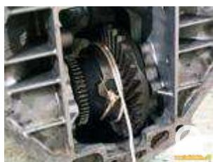
Faire tourner le différentiel de plusieurs tours pour centrer les roulements et enrouler une ficelle autour du boîtier de différentiel sur environ 1 à 2 tours.
