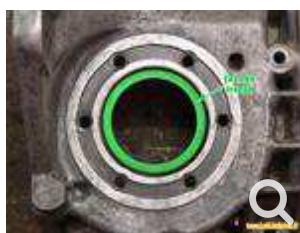
Déposer ensuite les bagues de roulement en les poussant vers l'intérieur à l'aide d'un chasse-goupille ou de tout autres outils adaptés.
