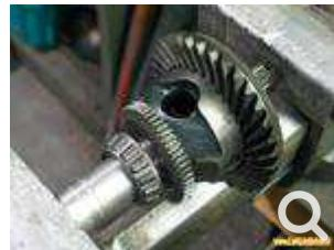
**Côté boitier :** reposer la roue de tachymètre sans oublier sa clavette puis, au marteau ou à la presse, reposer le roulement en tapant uniformément sur la bague extérieure à l'aide d'un tube de diamètre adapté. Si besoin utiliser l'ancienne cage de roulement pour aider à la repose.
