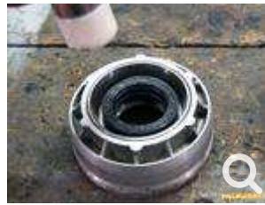
Pose du nouveau joint "au marteau"
