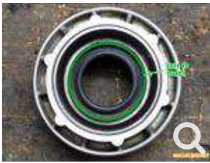
Zone de frappe pour repose du joint
