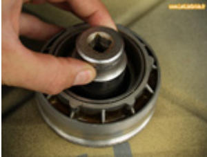
Pose du nouveau joint
