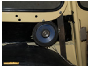
Enceinte fixée sur la 1ère plaque
