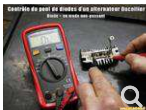
Diode + du 1 er bobinage en mode non-passant
