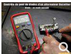
Diode + du 1 er bobinage en mode passant
