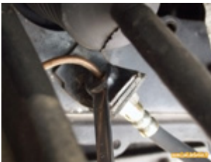
Démontage à la clef à tuyauter
