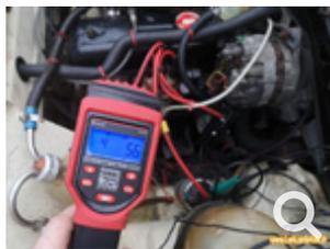
La vérification de la conformité du réglage de l'écartement des contacts passe par le [contrôle de l'angle de came / pourcentage de Dwell](#). Mais cela nécessite un moyen de mesure spécifique.
