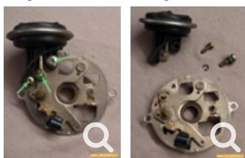
Une fois la platine déposée (cf. la dépose du contact mobile), retirer le clip "E" et les 2 vis qui maintiennent la capsule d'avance à dépression.
