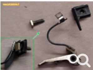
Pour finir, extraire le fil du contact mobile de la vis de liaison avec les fils de condensateur et de bobine.
