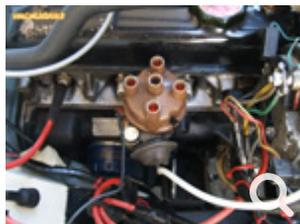
Retirer les fils de bougies sur la tête de l'allumeur (penser à noter le positionnement de ceux-ci!) ainsi que celui de la bobine d'allumage.
