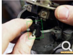
Retirer le 2 vis de fixation de la platine puis retirer celle-ci de l'allumeur. **Attention** : extraire en même temps que la platine le support de la vis des fils de condensateur et de bobine (cette vis est reliée à la platine par le fil du contact
