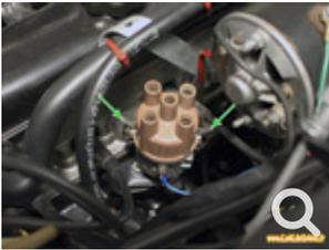
Retirer les clips de la tête d'allumeur et retirer celle-ci (elle est juste "posée" dessus).
