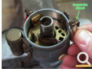
Retirer la vis qui maintient le contact fixe et déposer celui-ci.
