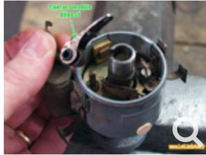
Retirer le contact mobile en faisant légèrement lever à l'aide d'un tournevis plat si besoin.
