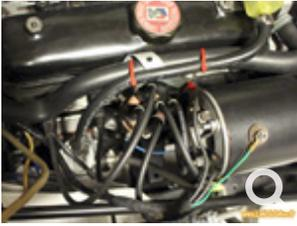
Retirer les fils de bougies sur la tête de l'allumeur (penser à noter le positionnement de ceux-ci!) ainsi que celui de la bobine d'allumage.
