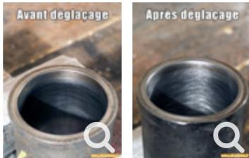
Ci-contre un cylindre avant et après déglaçage.
