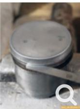
A l'aide d'un jeu de cale, mesurer le jeu latéral du segment lorsqu'il est dans la gorge du piston. Cette valeur doit être comprise entre 0,05 et 0,10mm. Ce contrôle peut être réalisé soit avec le segment déposé soit avec le segment déjà monté (cf. photos).
