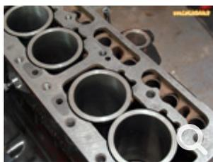
Positionner ensuite les 4 chemises dans le bloc sans y mettre de joint ou bien en y mettant chaque fois le joint de plus faible épaisseur.
