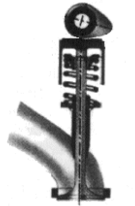
Ouverture de la soupape par la came (moteur à arbre à cames en tête)
