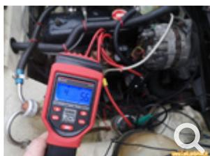
Il s'agit d'un simple contrôle : le réglage est réalisé en jouant sur l'écartement des contacts du rupteur et l'appareil permet de s'assurer que l'angle de came / Dwell est conforme.
