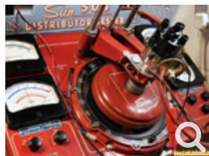
Le réglage précis de l'angle de came / Dwell se fait sur un banc de réglage pour allumeur type SOURIAU ou SUN (ou autre). Ce type de banc permet aussi le réglage de l'avance centrifuge et de l'avance à dépression (si présent) ainsi que de plein d'autres choses super cool.
