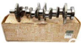
Le vilebrequin le dispositif mécanique qui permet, par l'intermédiaire des bielles, la transformation du mouvement rectiligne des pistons en un mouvement de rotation continu. C'est donc lui qui assure la transmission de l'énergie de combustion du carburant dans les cylindres en énergie mécanique disponible transmise à la boîte de vitesse. Il entraîne aussi l'arbre à came par le biais de la distribution.
