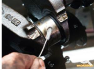
A l'aide d'un simple fil rigide (fil électrique par exemple), vérifier que rien n'obstrue les différents circuits de lubrification du vilebrequin.
