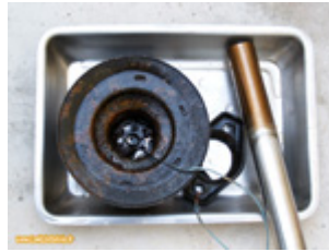
Sortie du bain électrolytique
