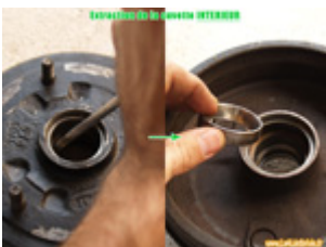
Extraction de la cuvette intérieure
